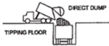
الشكل ١: التخلص المباشر من النفايات في قاطرة مكشوفة
