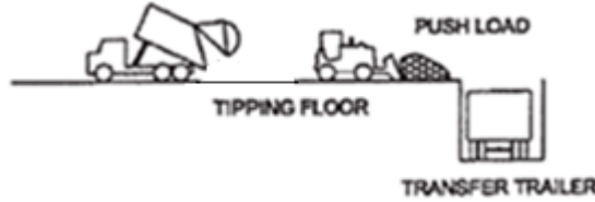
الشكل ٢: التخلص من النفايات على أرضية قلاب قبل تحميلها في القاطرة
